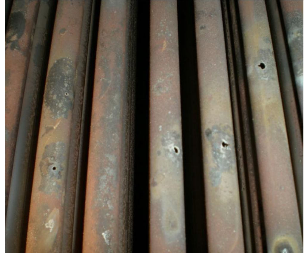
Abbildung Leckagen, Ablagerungen und Korrosion: Wasseraustritt mit massiven Salzkrusten, Ablagerungen von Kalk und Magnetit, Korrosion an wasserführenden Bauteilen.
