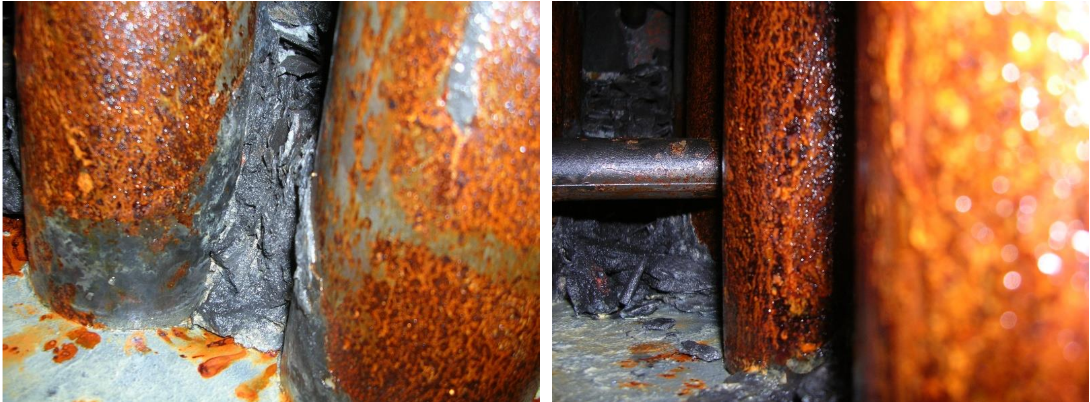
Abbildung Rauchgasrohre: Auswirkungen von mangelhafter Heiznetzwasserqualität in einem Wärmeerzeuger: Erosion, Korrosion und Ablagerungen von Kalk und Magnetit. Folgen sind sinkende Wirkungsgrade sowie Leckagen durch Spannungsrisse.
